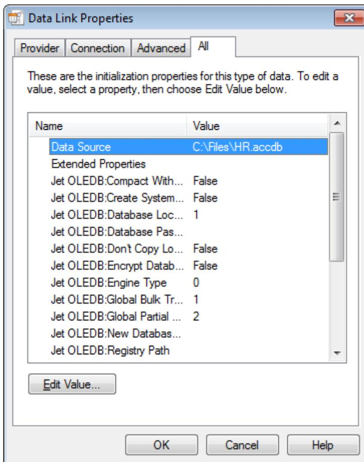
Все свойства и их значения представлены в виде таблицы. В поле **Name** отображается параметр, в поле **Value** - его значение. Имеется возможность открыть диалоговое окно Изменение значения свойства, дважды щелкнув нужное свойство или нажав кнопку **Edit Value**. Для изменения свойства предназначено диалоговое окно **Edit Property Value**.
