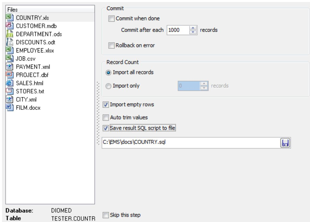
Если установлен флажок **Skip this step**, то этот шаг будет пропускаться при последующем импортировании файлов. Список пропускаемых шагов можно просмотреть и изменить на вкладке [General](#)<sup>[71]</sup> диалогового окна [Preferences](#)<sup>[70]</sup>.
